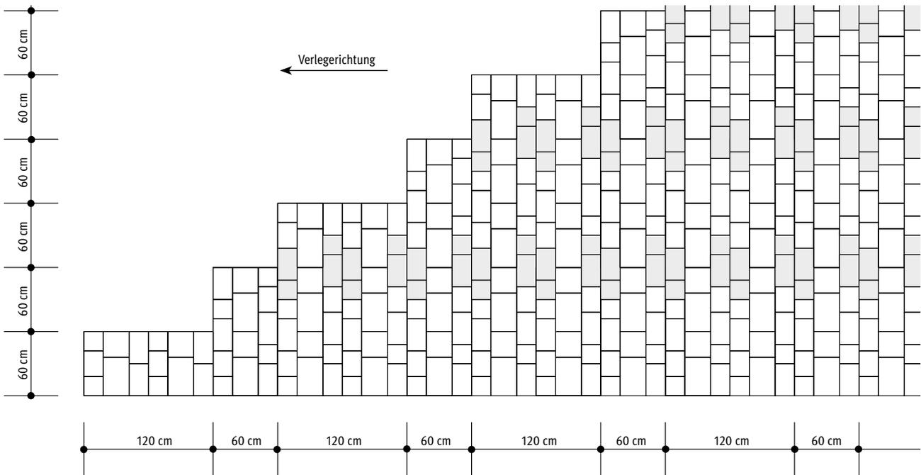
Ideal für GEOSTON CARMA protect ist die klassische Bahnenverlegung. Hier werden alle Steine verwendet, es bleibt kein Stein übrig. Für den Randabschluss müssen bei Einhaltung dieses Rasters keine Steine geschnitten werden.
